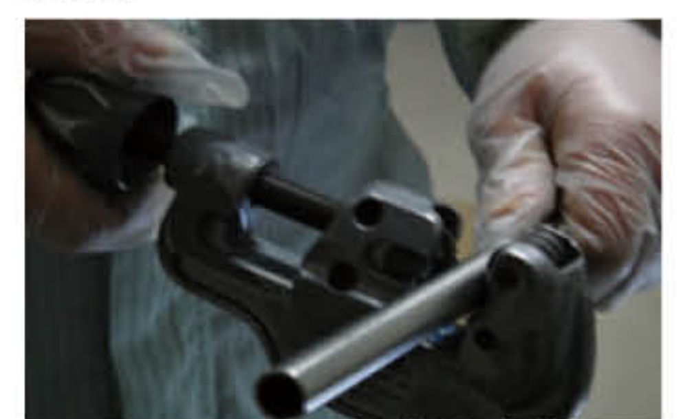
图5.2.3-1 采用手动切管器切割管材
