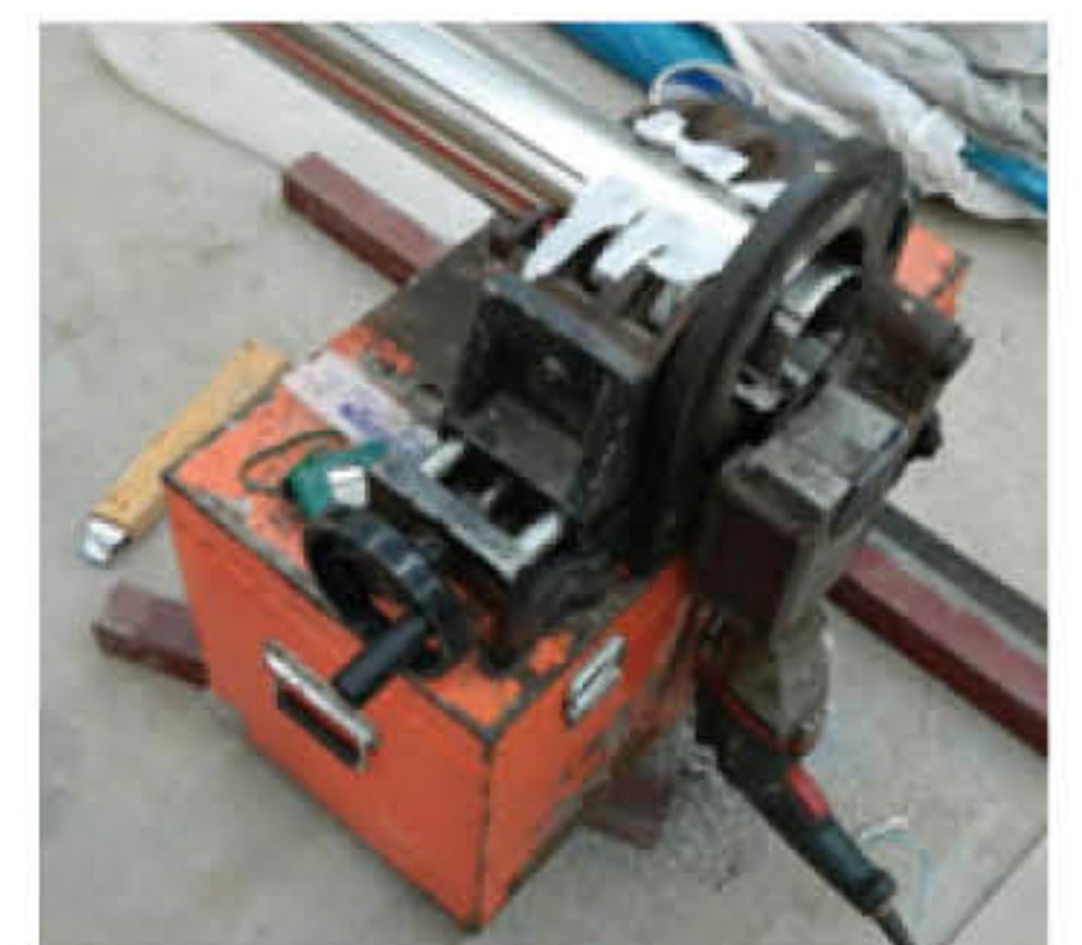
图5.2.3-2 采用自动切割机切割管材
